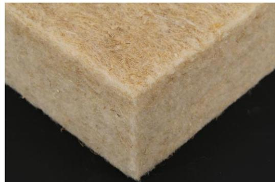
Abbildung 17 Dämmstoffe aus Hanffasern
