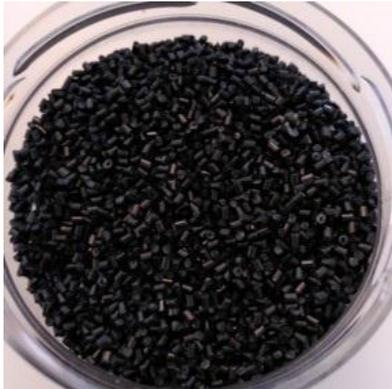
Abbildung 83: Regranulat (Bildnachweis: [www.polystyreneloop.eu](http://www.polystyreneloop.eu))
