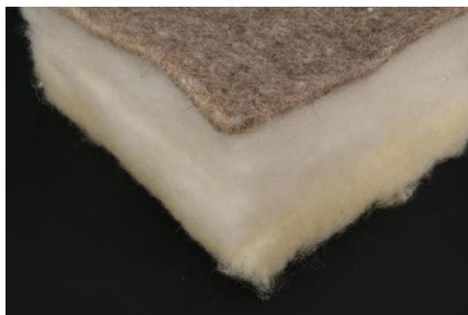
Abbildung 29 Dämmstoff aus Schafwolle
