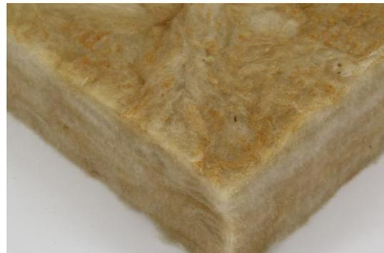
Abbildung 23 Dämmstoffe aus Mineralwolle
