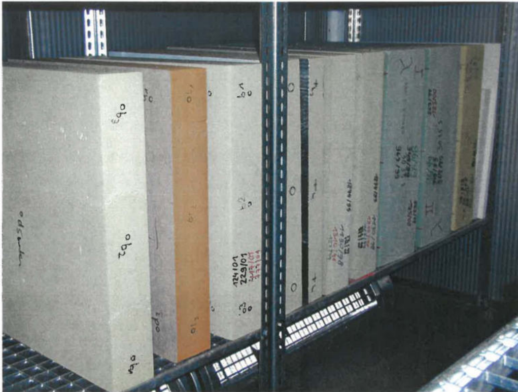
Abb. 15: Lagerung der Probekörper für die Dimensionsstabilität und der Wärmeleitfähigkeit im Normklima bei 23 °C/50 % relativer Feuchte
