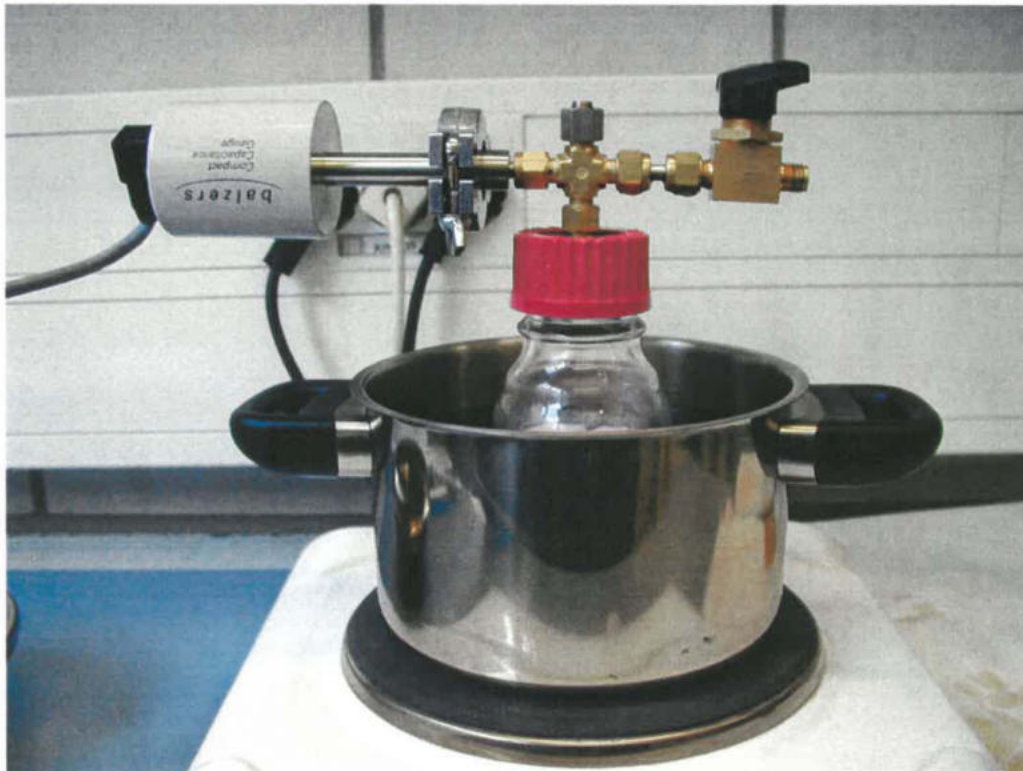
Abb. 59: Schmelzen der XPS-Probekörper in einem Ölbad
