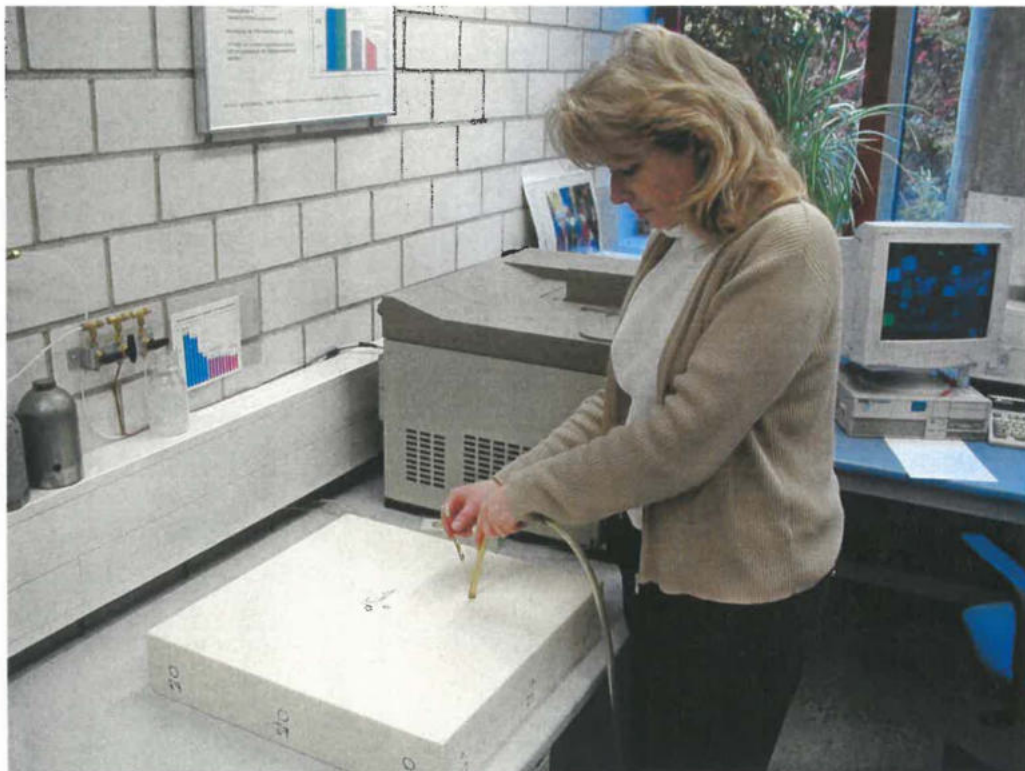
Abb. 6: Entnahme der Zellgasproben
