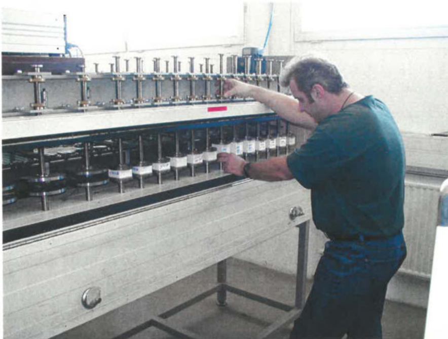
Abb. 9: Bestimmung der Verformung bei definierter Druck- und Temperaturbeanspruchung
