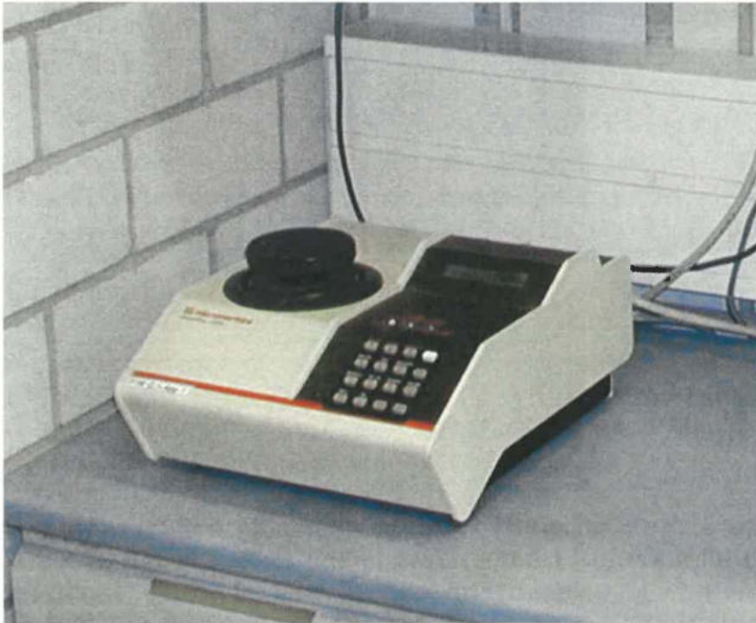
Abb. 4: Gas-Pycnometer zur Bestimmung der Geschlossenzelligkeit
