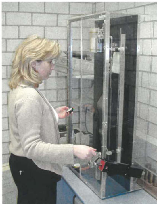
Abb. 3: Bestimmung der Geschlossenzelligkeit mit der Volumenausdehnungsmethode nach DIN/ISO 4590
