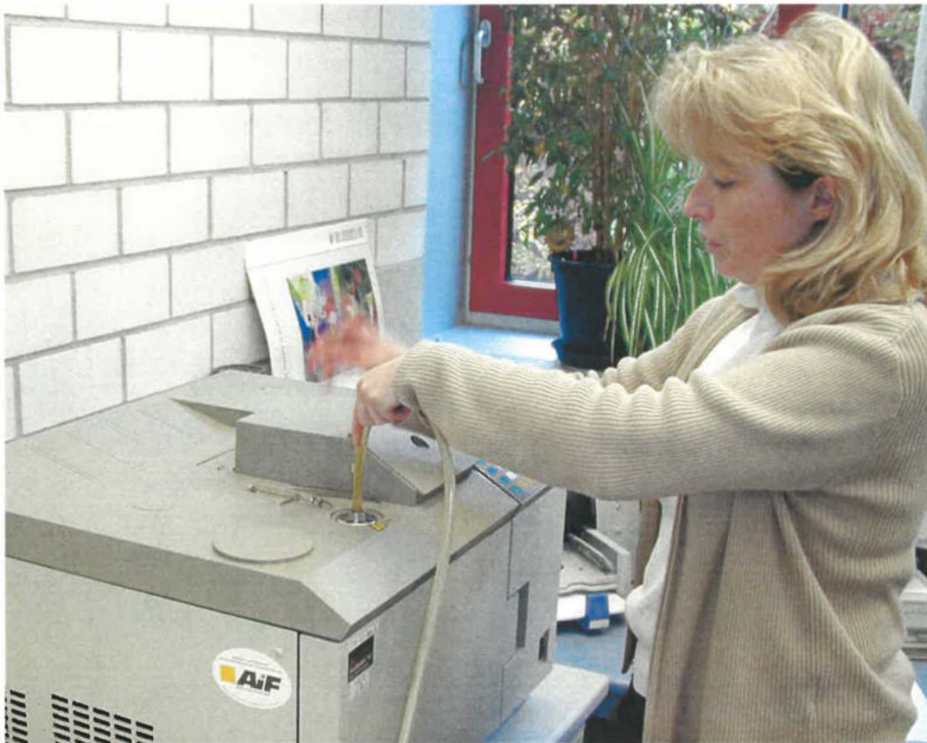
Abb. 7: Einbringen der Zellgasprobe in den Gaschromatographen
