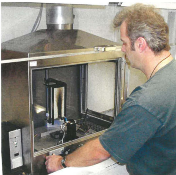
Abb. 10: Prüfung der Baustoffklasse B2 mit dem Kleimbrennertest
