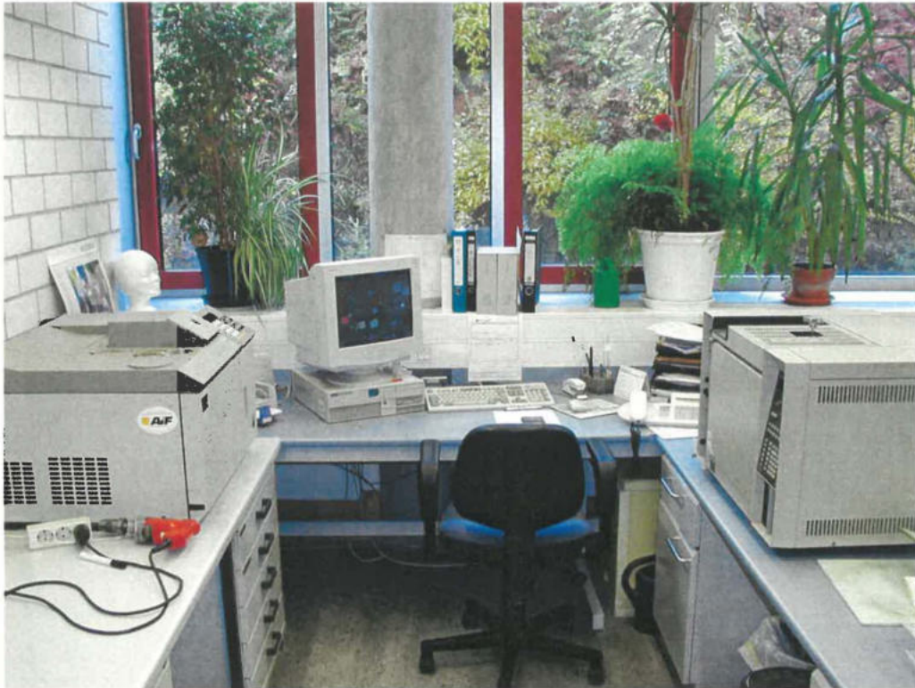
Abb. 5: Messplätze zur Bestimmung der Zellgaszusammensetzung
