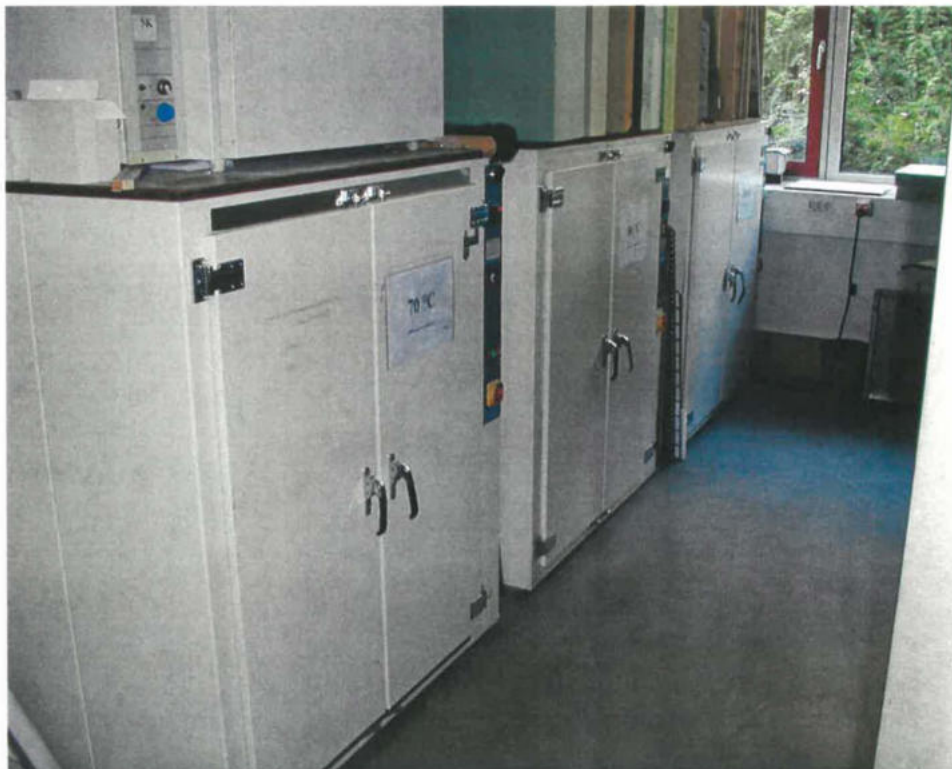
Abb. 16: Wärmeschränke zur Lagerung der Probekörper für die Dimensionsstabilität und der Wärmeleitfähigkeit bei den Temperaturen 70 °C, 80 °C und 100 °C
