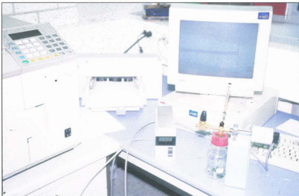
Bild 22: Untersuchung der 50 \mu l Gasprobe aus dem Probenbehälter nach dem Schmelzvorgang im Gaschromatographen
