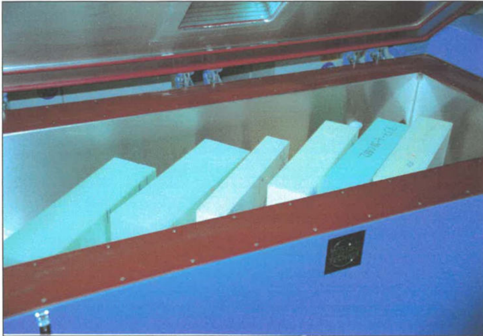
Bild 9: Lagerung der Hartschaum-Probekörper bei -30^{\circ}\text{C} in der Tiefkühltruhe
