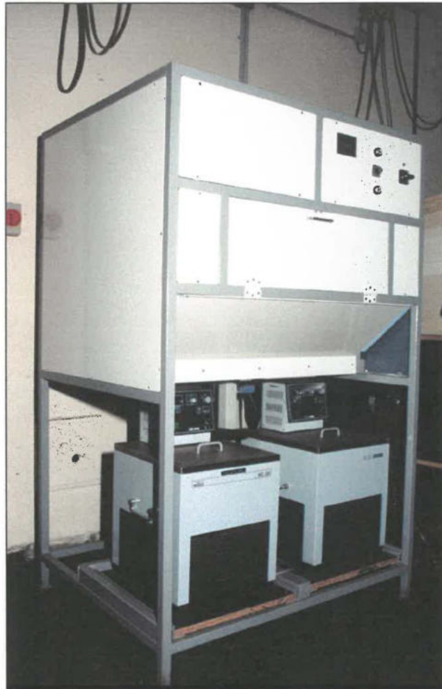
Bild 1: Einplattengerät mit 2 Kältethermostaten zur Bestimmung der Wärmeleitfähigkeit
