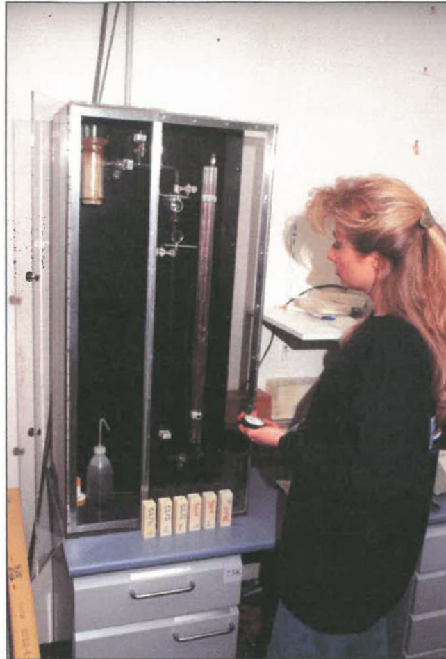
Bild 3: Prüfeinrichtung nach ISO 4590 zur Bestimmung des Volumenanteils geschlossener Zellen
