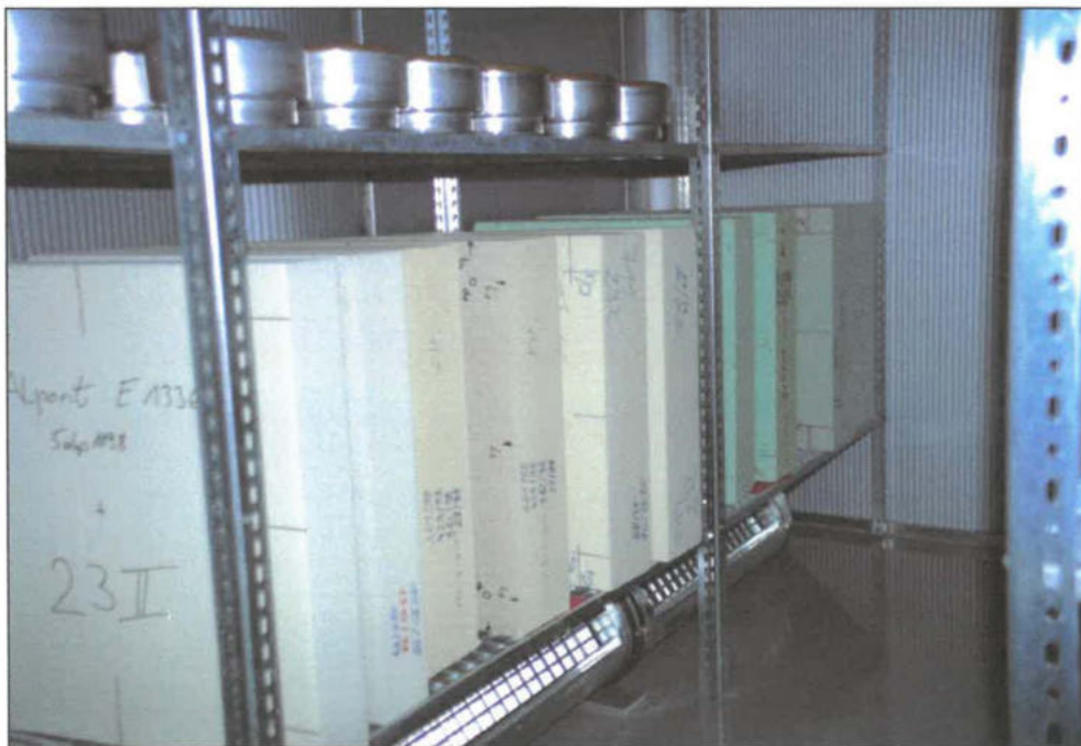
Bild 10: Lagerung der Hartschaum-Probekörper bei (23 \pm 1)^{\circ}\text{C} / (50 \pm 3)\% relativer Luftfeuchte zur Bestimmung der Dimensionsstabilität
