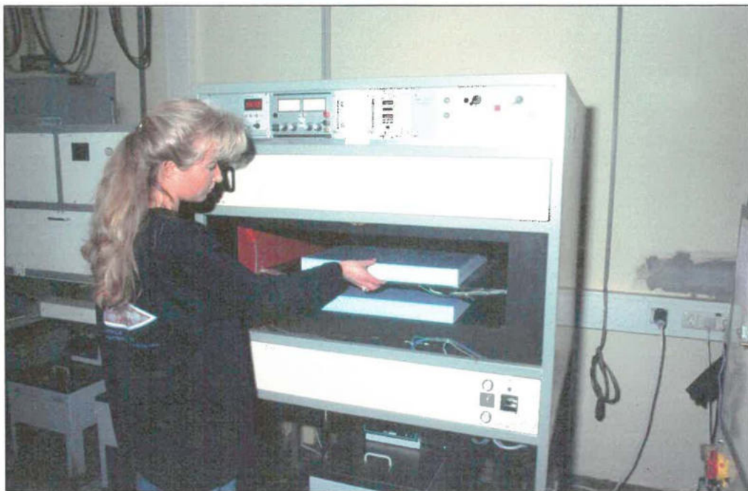
Bild 2: Einbringen von zwei Hartschaumplatten in das Prüfgerät Nach DIN 52612
