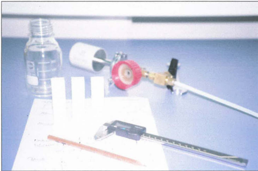
Bild20: Aus den gelagerten 20mm XPS-Schaumschichten werden drei Quader von 20mm x 20mm x 75mm geschnitten und vor dem Einbau vermessen
