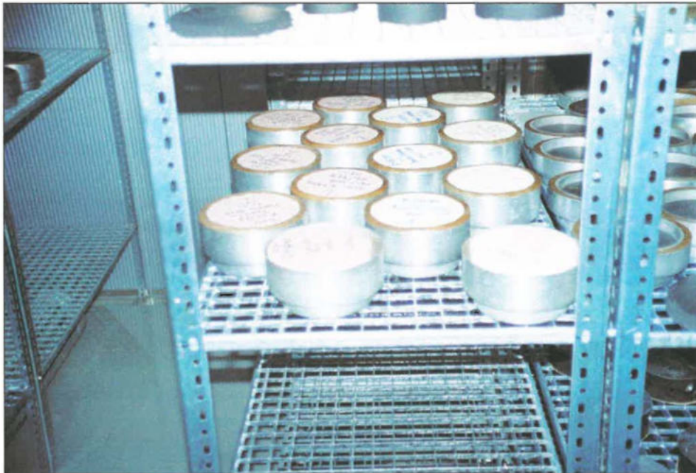
Bild 11: Bestimmung der Wasserdampfdurchlässigkeit von PUR-Hartschaum-Probekörpern
