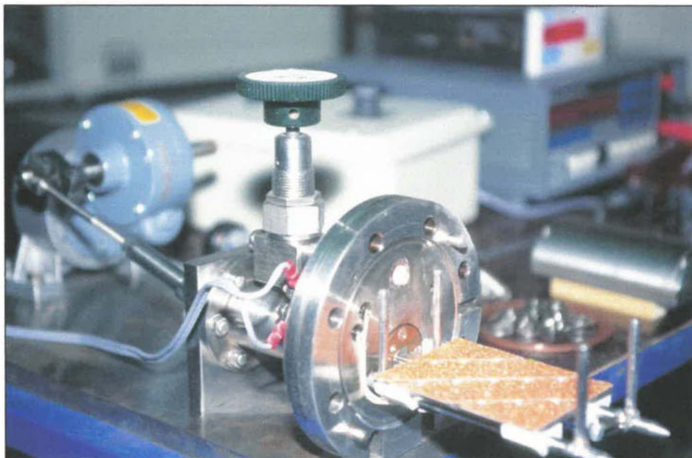
Bild 17: Geöffnete Prüfapparatur mit oszillierendem Schleifschlitten, der einseitig mit Schleifpapier beklebt ist
