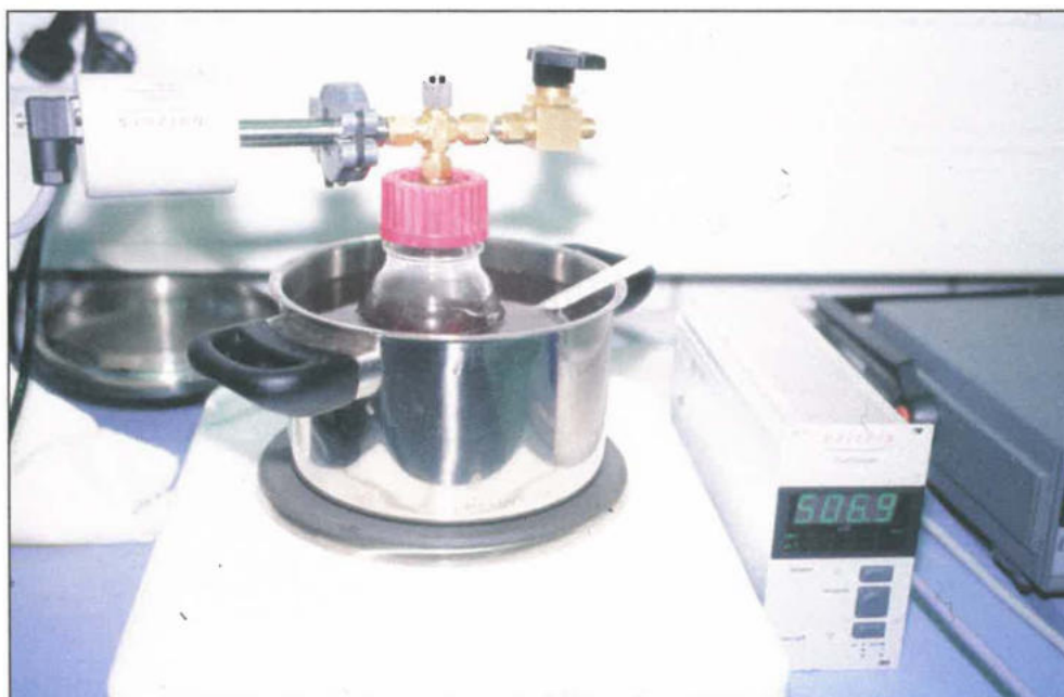
Bild 21: Schmelzen der XPS-Probekörper bei 180 - 200°C im Ölbad
