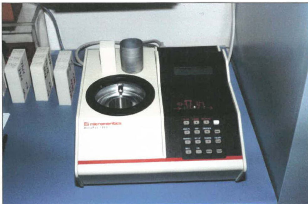
Bild 4: Vollautomatischer Gas-Pycnometer der Firma „micromeritics“ zur Ermittlung der Geschlossenzelligkeit
