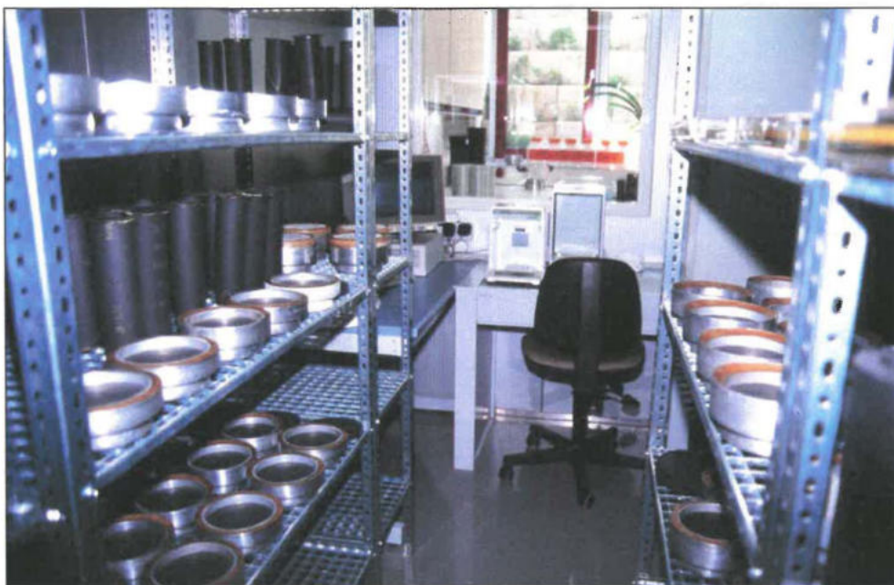
Bild 12: Klimatisierter Prüfraum 23°C / 50% relativer Luftfeuchte mit Prüfgefäßen zur Bestimmung der Diffusionswiderstandzahl \mu
