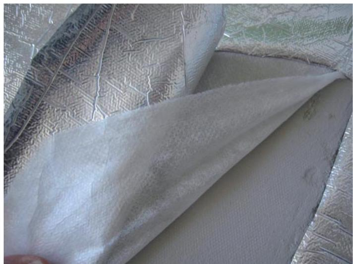
Üblicher Aufbau eines VIP: Stützkern aus gepressten Kieselsäureplatten mit Vlies als Staubschutz und mehrlagiger Barrierefolie
