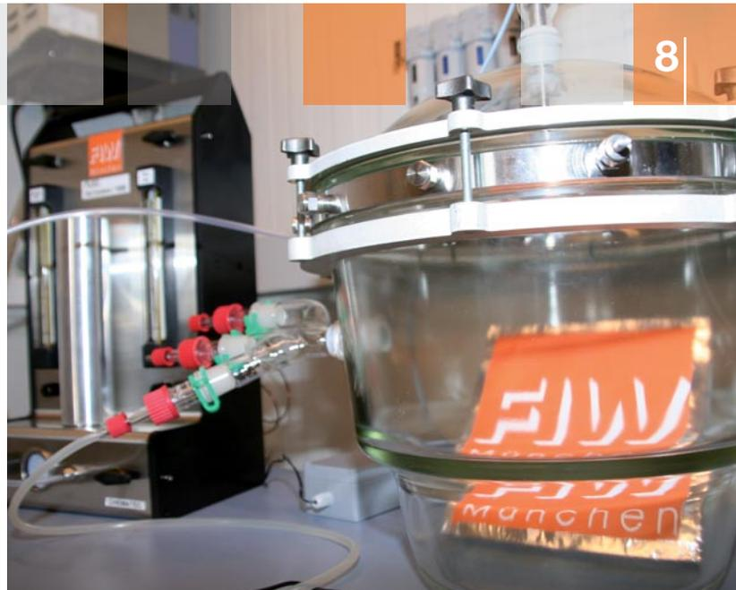
Emissionsmessung in einer 24l-Kammer
