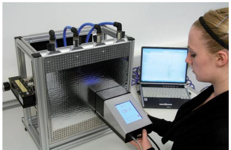
Bestimmung des Wärmeemissionsgrades von Folien mit dem Gerät INGLAS TIR 100-2. Die Folie wird gehalten von einer Probenhalterung mit thermischer Ankopplung (Eigenbau)
