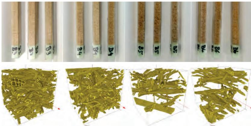
**Abb. 1 oben:** Probenpräparation von Holzfaserdämmstoffen unterschiedlicher Dichte (FIW)
