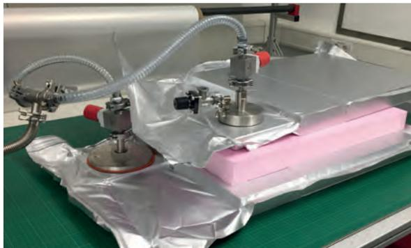
**Abb. 2:** Probekörper zur Bestimmung der Anteile der Wärmeübertragungsmechanismen mit Folienumhüllung und angeflanschem Evakuieradapter
