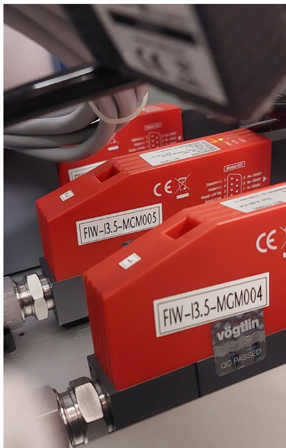
Einsatz präziser Massendurchflussregler am FIW München
