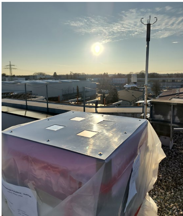
Prototyp zur Materialcharakterisierung auf dem FIW-Dach samt Messequipment.
